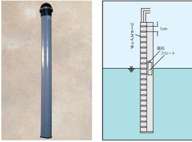
■ デジタル水位測定柱 機器構成
